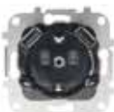
Розетка SCHUKO со встроенным 2xUSB зарядным устройством Номинальное напряжение: 250 В~ Номинальный ток: 16А Тип F: 2P + E С защитными шторками. USB зарядное устройство, тип А. Номинальное напряжение на выходе: 5 В пост. тока ±5%. Номинальный ток на выходе: 2000 мА. Энергопотребление в режиме ожидания: ≤0,015 Вт Энергоэффективность: ≥79 %. Рабочая температура: от 0 °С до +45 °С. Защита от перегрева. Индикатор работы устройства LED. Винтовые клеммы. Без распорных лапок. Накладка: арт. 8588.3 ХХ.
